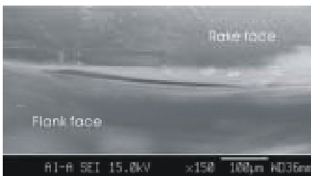
図1 工具摩耗観察写真の一例 (R=2mm, L=1995km)
