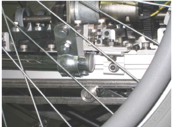
図6 車いすへの架台の取付け状況
