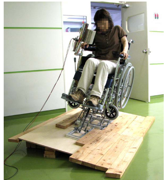
図13 モニターによる最大昇降時の安定性実験
