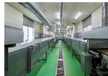
長さ約90メートルの蒸しライン
