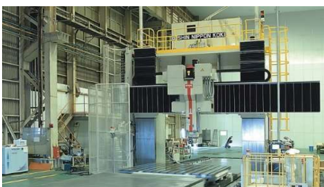
大型五面加工機(X9000、Y3500、Z4000)
