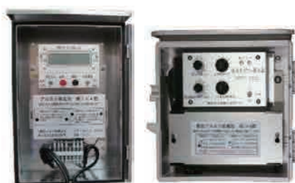
防霜散水器、灌水タイマー散水器
