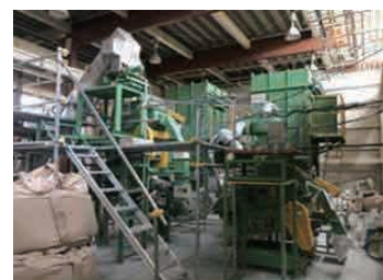
鹿児島県工業技術センターと開発した多段気流分級装置
