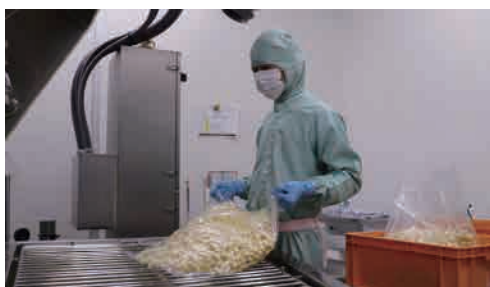
生にんにくを製造機に投入
