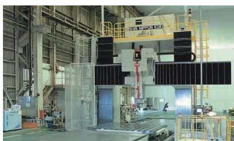
大型五面加工機(X9000、Y3500、Z4000)
