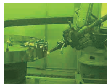
ロボットによる溶接加工の様子
