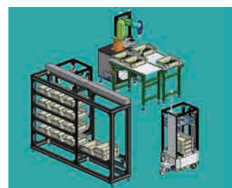
TMS(ロボットアーム、AGV、自動倉庫)
