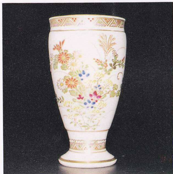
微粒シラスバルーンを用いた軽量陶磁器
