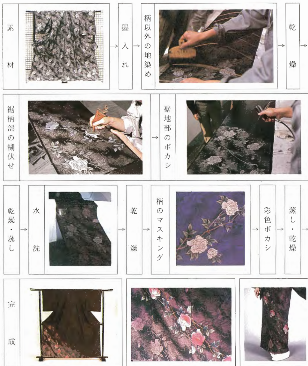
図2. 試作2 刷毛及びエアブラシによる自然ボカシ法の作業手順フロー
