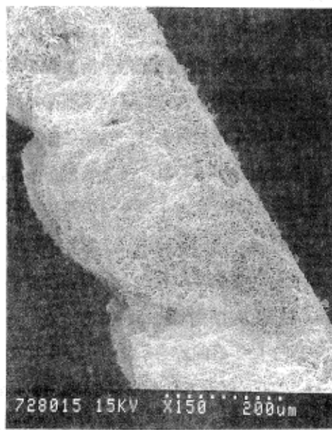
写真4 SAPO-5膜の断面 TEOS, AIP, 72時間
