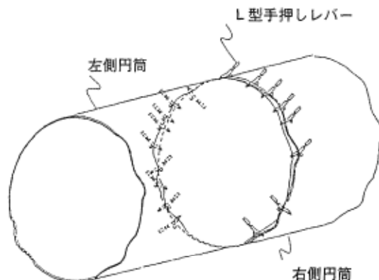
図2 L型手押しレバーによる従来工法 (全体図)
