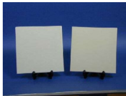
図3 プレス成形陶板 （左：薩摩焼陶板 右：軽量陶板）
