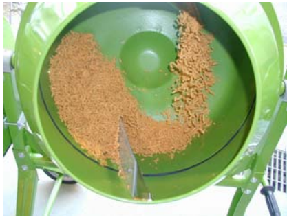
図2 ミキサーによる麴の造粒
