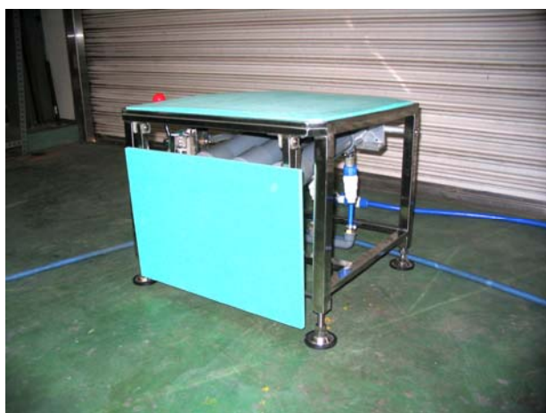
図1 開発済みの足上げ機構付き移乗台
