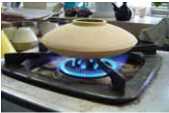
熱衝撃試験の様子(写真は素地試験の様子)
