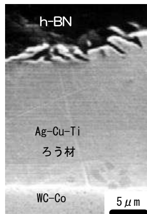
図1 接合界面の断面観察結果
