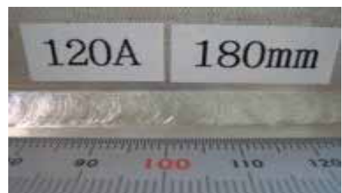
図3 4mm水平すみ肉溶接のビード外観
