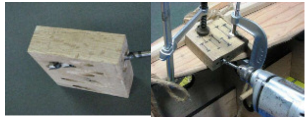
図6 底板を竜骨へ接合する穿孔用治具
