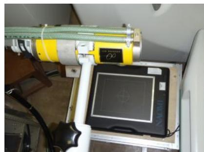
図1 X線発生器及びセンサー
