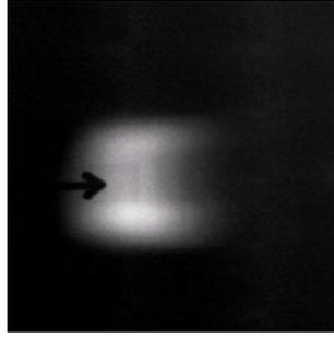
図4 コリメータを用いた透過度計の2倍拡大撮影
