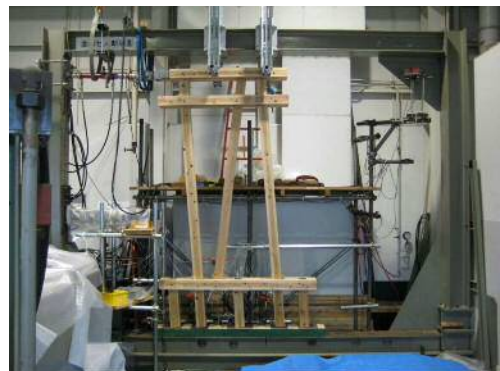
図3 軸組壁体の面内せん断試験状況
