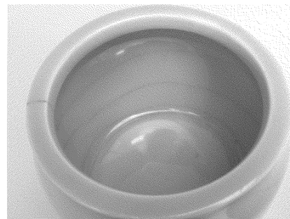
図1 貫入の発生状況
