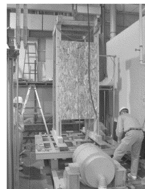
■ 立体軸組振動試験
