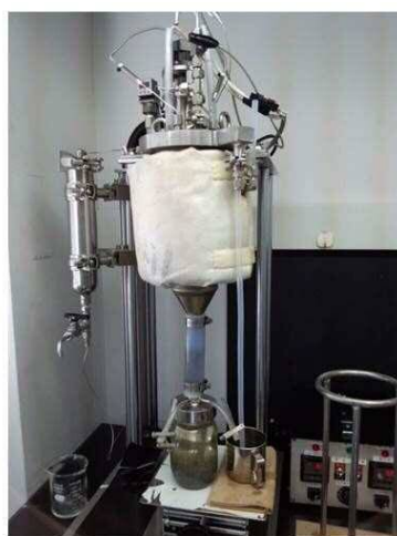
図2 はんだパウダー製造装置の外観及び構造
