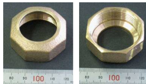
外表面 内側加工面 図1 鑄造加工部品（ナット）
