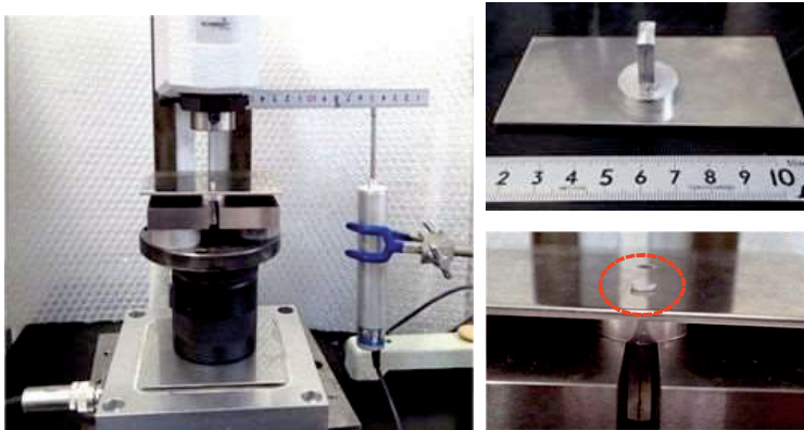
図5 かしめ加工実験装置と加工品写真
