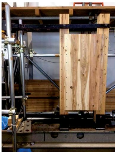
図2 簡易試験体面内せん断
