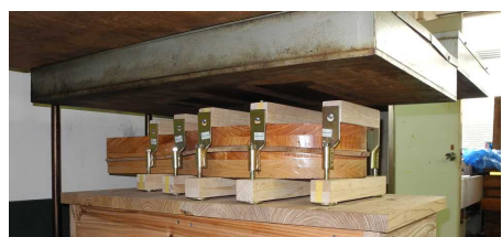
図10 プレスによる治具圧縮
