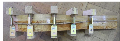
図8 煮沸後に腹板を成形治具で圧縮
