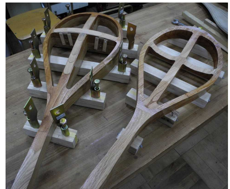
図7 収縮を妨げない成形治具
