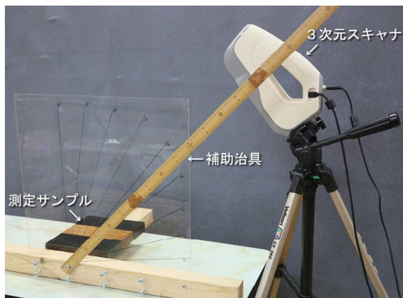
図3 測定サンプルと治具
