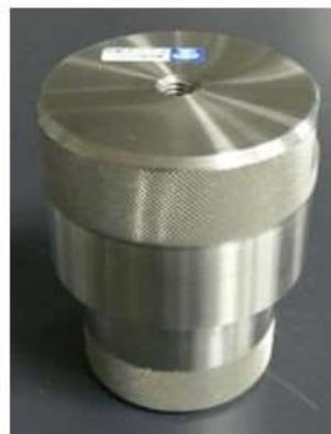
図 2 水熱処理に用いた耐圧容器.
