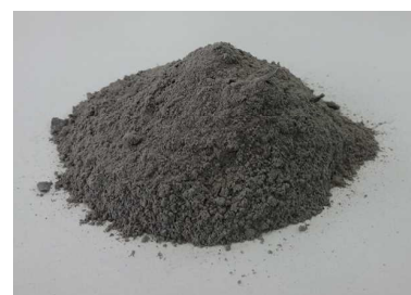
図2 木質バイオマス燃焼灰
