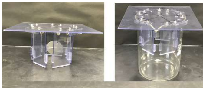
図1 攪拌洗浄試験用治具
