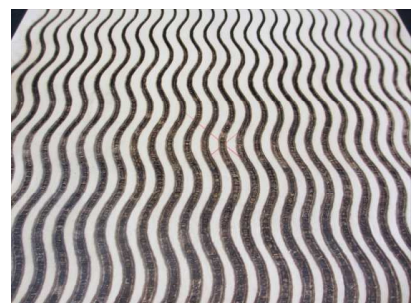
図3 傾斜をつけて加工した型板
