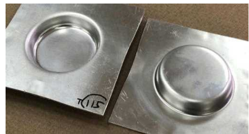
図7 プレス結果(アルミ板厚1.0)
