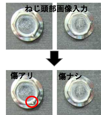
図 2 実装AI②ねじ頭部の傷検出
