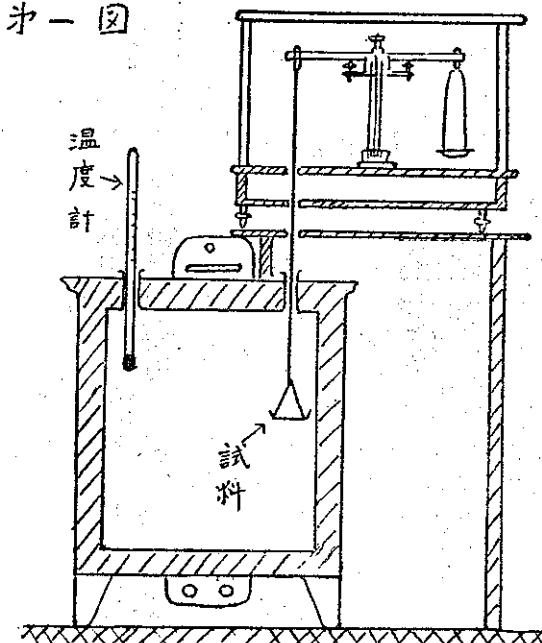
[実験] 菜種に適当に水分を吸はせた後試料皿に乗せ時間と共に重量の減少するのを秤量する。
