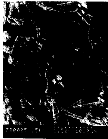
写真5 溶液側 (SiO 2 源:ケイ酸エチル)
