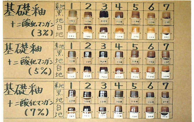
写真3 着色酸化マンガンテストピース
