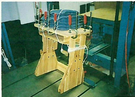
図8 机の繰返し耐衝撃性試験
