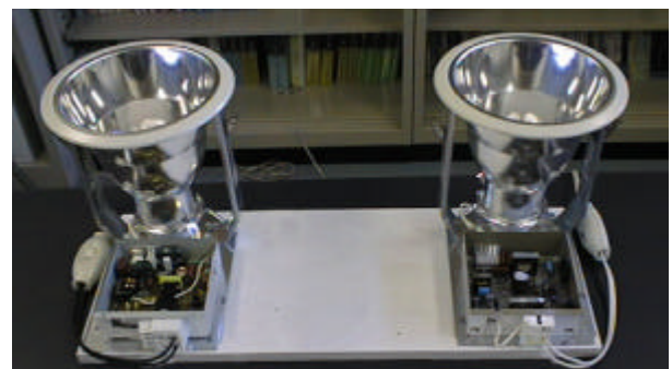
図2 蛍光灯ダウンライトの全体写真 (左：従来品, 右側：開発品)
