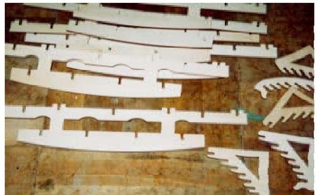
図17 炭酸ガスレーザーで加工した屋根部品
