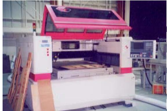
図3 炭酸ガスレーザ加工機
