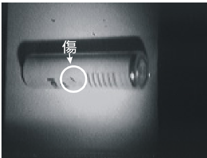
図15 分光画像による傷の検出（波長700nm）
