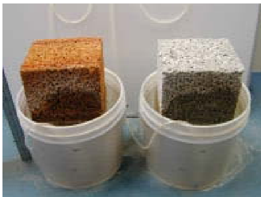
図3 回分式による水質浄化試験 (左:成形体B 右:成形体A)
