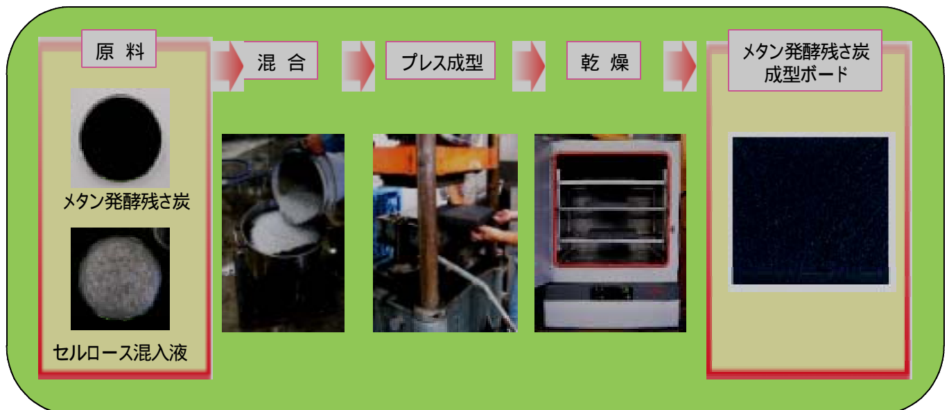
図3 乾式メタン発酵残さ炭を用いた成型ボードの製造方法
