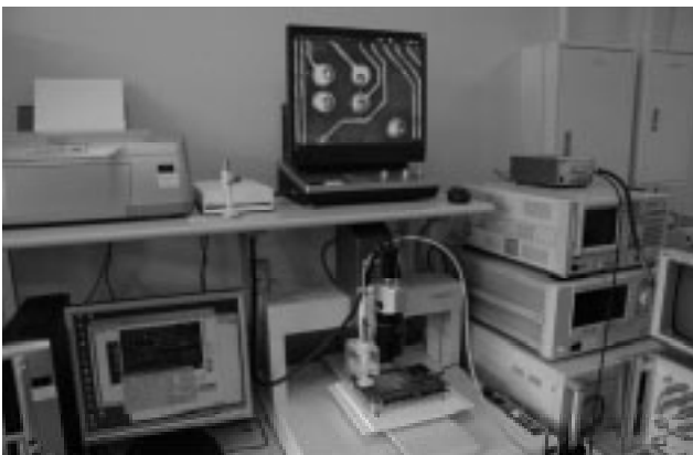
図3 開発した解析システム (左下から制御用PC, 精密XYZステージ, ノイズ発生器類)
