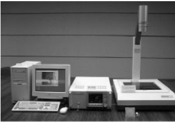
図2 従来の解析システム (左から制御用コンピュータ, ノイズ発生器, XYステージ)
