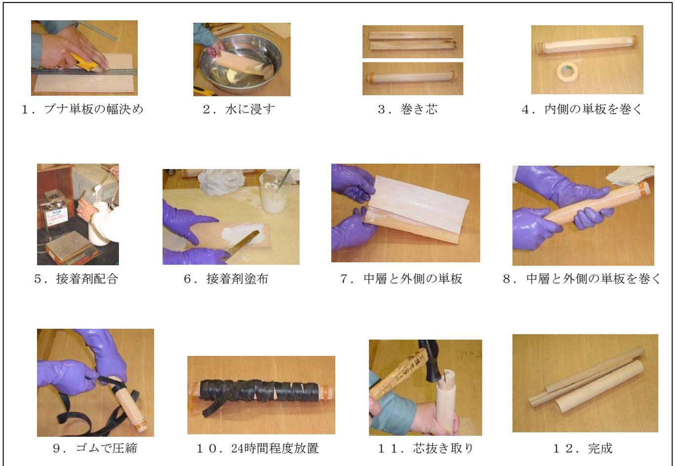
図2 ウッドパイプの製造法
