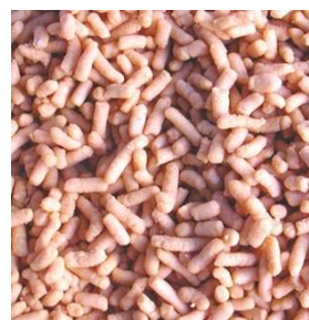
図4 ミキサーによる円柱状の造粒物
