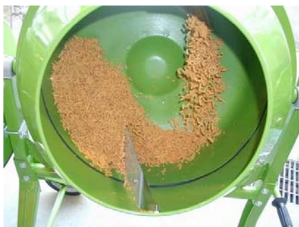
図3 ミキサーによる麴の造粒
