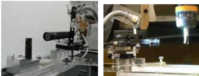
(a) オフライン実験 (b) オンライン実験 図11 工具摩耗測定実験の様子
