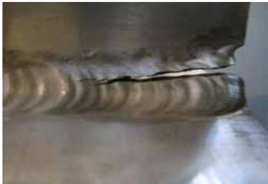
図7 入熱過大による高温割れ
