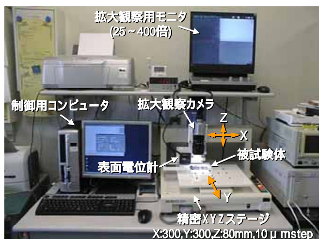
図1 開発した静電気帯電分布可視化システム
