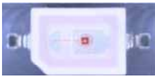
図7 LEDチップとボンディング線の位置の違い (図4と位置が異なる)
