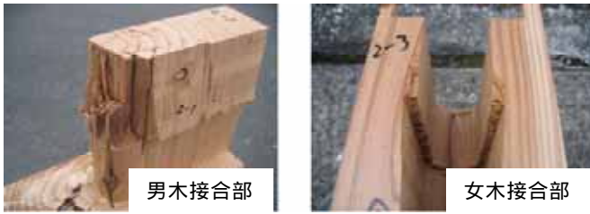
図17 せん断破壊タイプ
