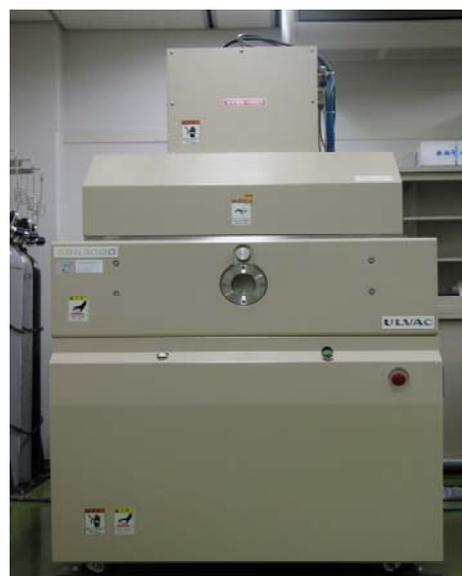
図1 スパッタリング装置本体
